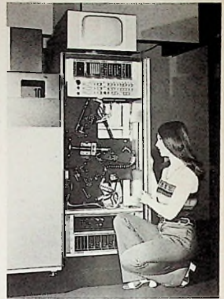
Voor KTV-opnamen heeft RCA het TK-28 systeem ontworpen. De camera heeft drie vidicons (lood-oxyde buizen) en corrigeert automatisch de kleurbalans en andere technische variaties tijdens het opnemen van programma's. Het systeem kan zelfstandig of gekoppeld aan een RCA TP-55B multiplexer opereren.
